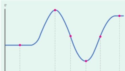
$t_1, t_2, t_3, t_4, t_5$  در نمودار  $v-t$  ، موازی محور زمان است در نتیجه شتاب صفر است.
