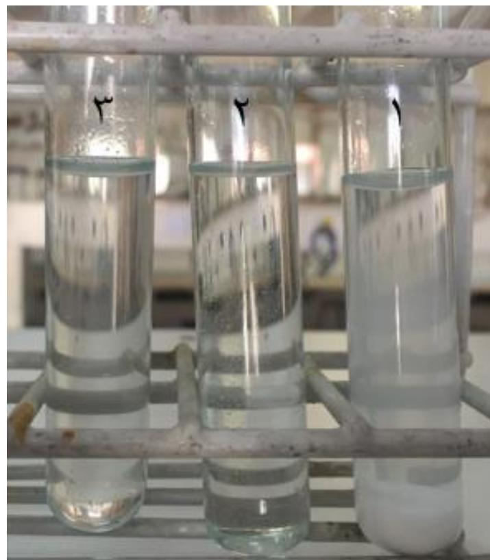
لوله آزمایش شماره ۱ حاوی باریم سولفات، لوله آزمایش شماره ۲ حاوی پتاسیم نیترات و لوله آزمایش شماره ۳ حاوی پتاسیم کلرید در حمام آب  $25^{\circ}\text{C}$ .
