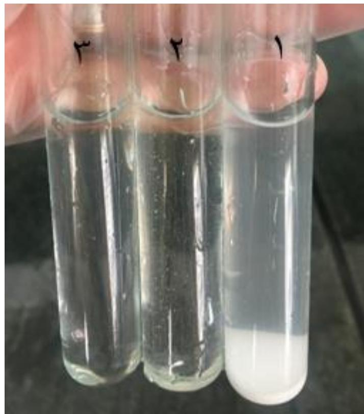
لوله آزمایش شماره ۱ حاوی باریم سولفات، لوله آزمایش شماره ۲ حاوی پتاسیم نیترات و لوله آزمایش شماره ۳ حاوی پتاسیم کلرید در حمام آب  $15^{\circ}\text{C}$ .
