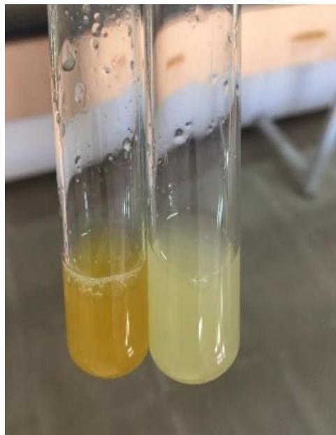
لوله آزمایش سمت راست آب پرتنقال و لوله آزمایش سمت چپ آب پرتنقال حاوی بتادین (تغییر رنگ داده)
