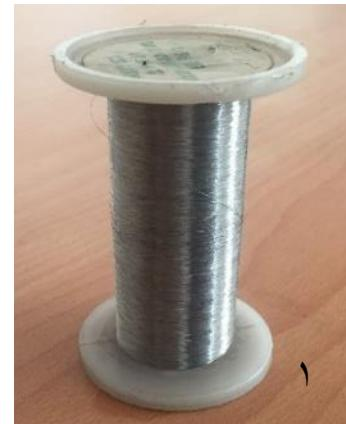
تصویر ۱، سیم نازک نیکل-کروم، تصویر ۲ یک قطره روغن کرچک و تصویر ۳ خط کش مجهر به ذرهبین برای اندازه‌گیری قطر قطره را نشان می‌دهد.
