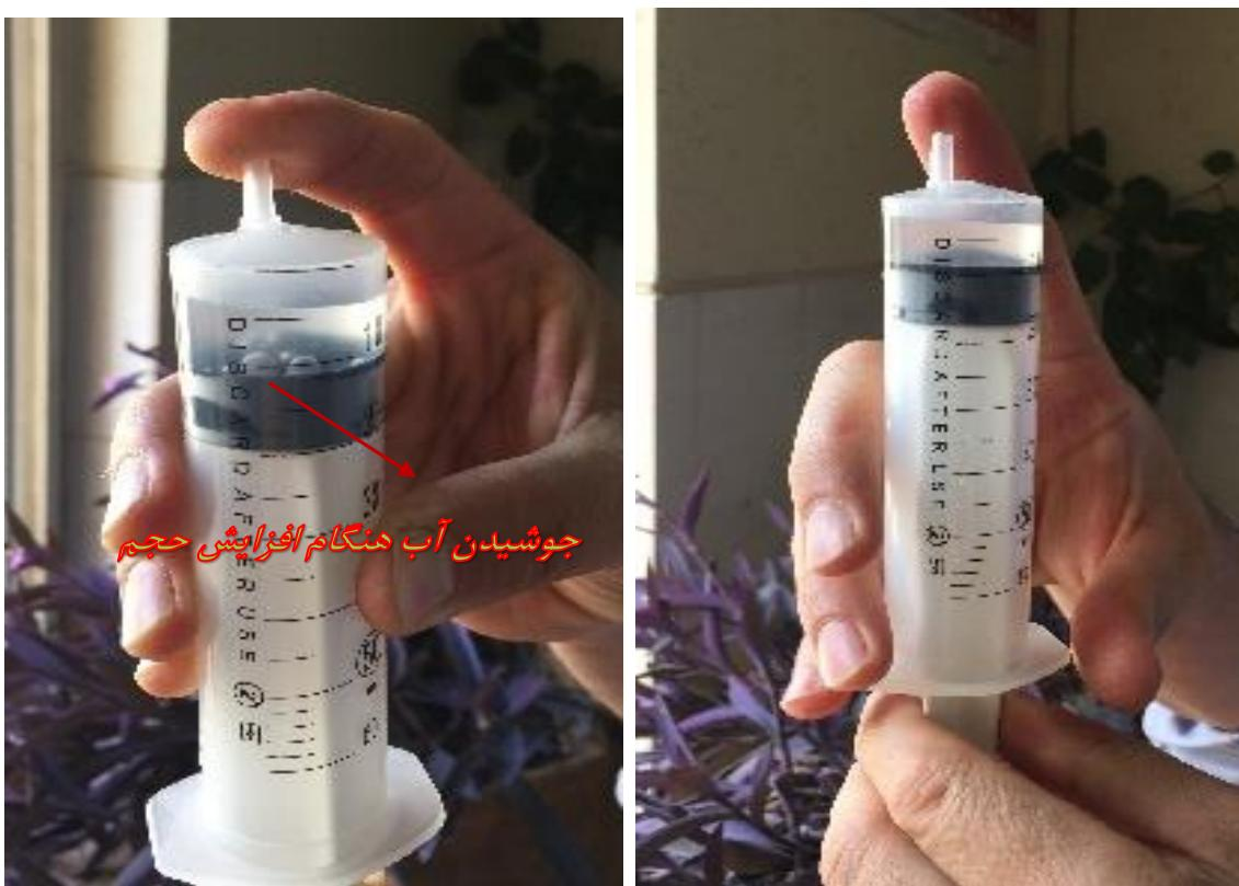
تصویر سمت راست: ۵ میلی‌لیتر آب ۵۰ درجه‌ی سانتی‌گراد همراه با یک میلی‌لیتر هوا در سرنگ ۶۰ میلی‌لیتری و تصویر سمت چپ جوشیدن آب در سرنگ درسته در اثر کشیدن پیستون (به حباب‌های ایجاد شده دقت کنید)
