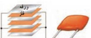
خازن های میکا بین ورقه های فلزی نازک قلعی، ورقه های نازک میکا قرار می دهند و ورقه های قلع را یک در میان به یکدیگر وصل می کنند. ظرفیت این خازن ها حدود ۵۰۰۰ پیکوفاراد است.
