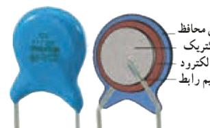
خازن های سرامیکی دی الکتریک این خازن ها سرامیک است که با استفاده از انواع سیلیکات ها در دمای بالا تهیه می شود. ثابت دی الکتریک این خازن ها زیاد و در حدود ۱۰۰۰۰ است. خازن های سرامیکی به شکل عدس تهیه می شوند و حجم آنها کم است. صفحه های رسانای آنها نیز با ذوب نقره در دو طرف سرامیک تهیه می شود. ظرفیت این خازن ها حدود ده ها نانوفاراد  $nF$  است.
