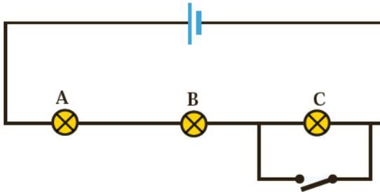
الف) بابتستن کلید و اتصال کوتاه، لامپ C از مدار حذف می شود و چون جریان الکتریکی از مقدار  $\frac{\epsilon}{3R}$  به  $\frac{\epsilon}{2R}$  افزایش می یابد اختلاف پتانسیل هر کدام از مقاومت های مشابه A و B از  $\frac{\epsilon}{3}$  به  $\frac{\epsilon}{2}$  افزایش می یابد.
