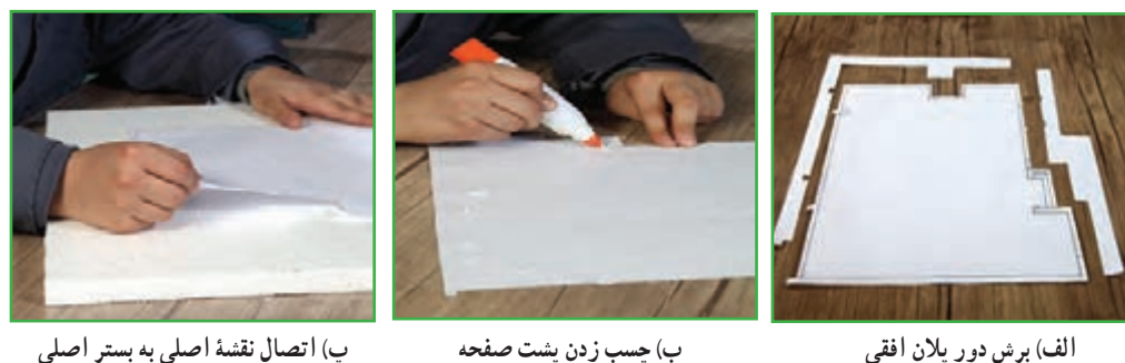
شکل ۹-۹. برش بستر ماکت ساختمان
