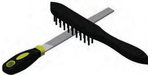
شکل ۱۷-۵. تمیز کردن سوهان با برس سیمی
