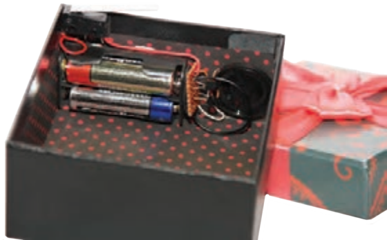
شکل ۲۸-۴. جانمایی مدار پروژه و کلید
