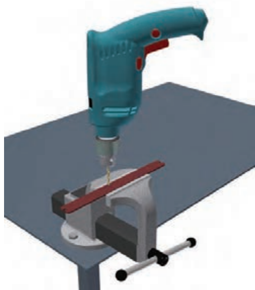
شکل ۵-۲۳. سوراخ کاری با دریل
