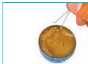
ب) آغشته کردن پایه‌ها به روغن لحیم
